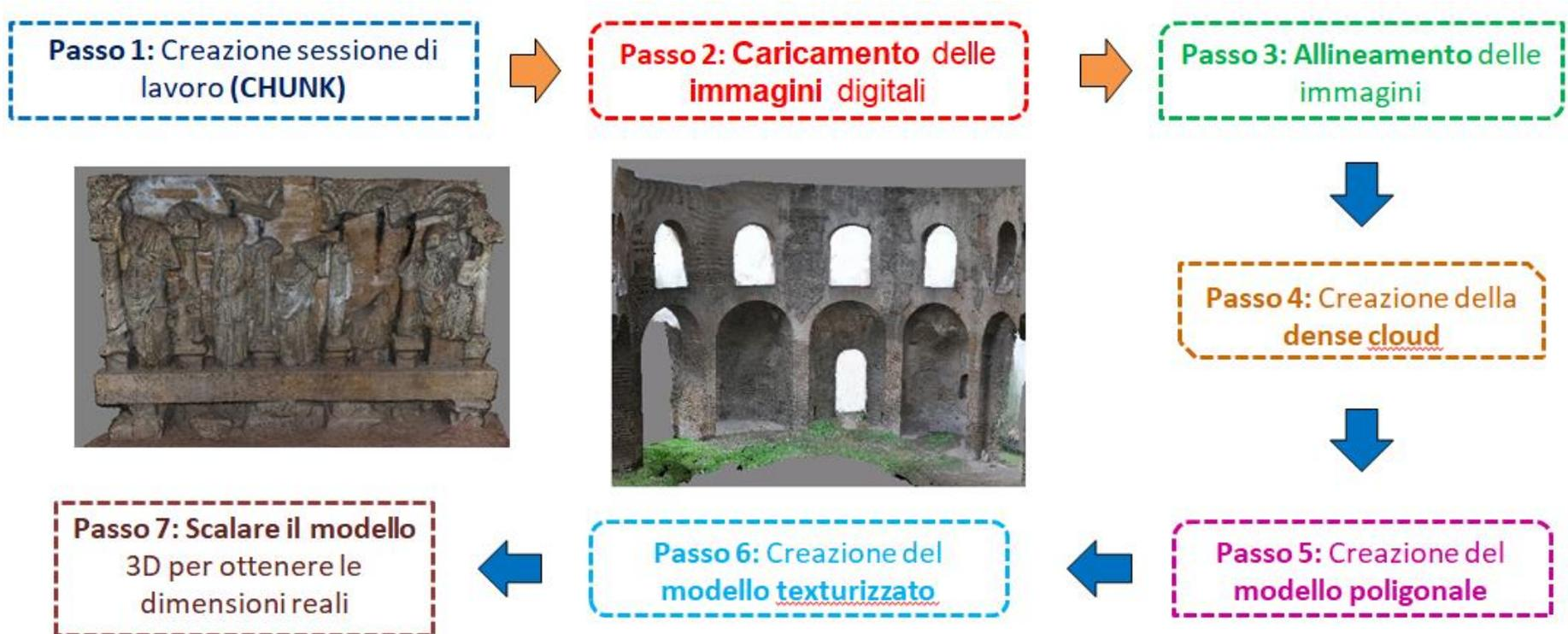
Workflow base per la ricostruzione 3D
