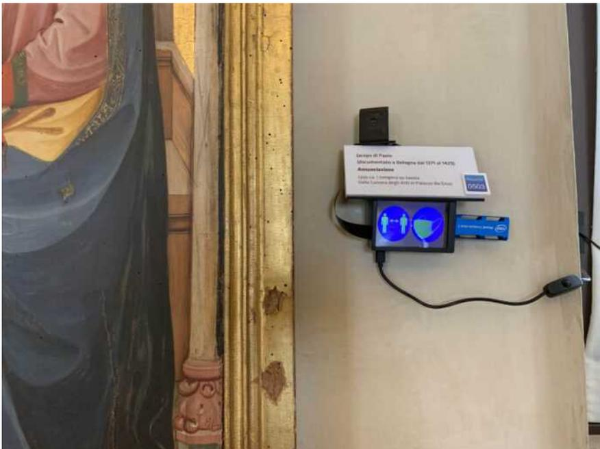
Il sistema si compone di una serie di dispositivi di acquisizione dati, oggi disponibili sul mercato a costi contenuti, che, provvisti di telecamera, raccolgono le informazioni e le inviano a un server centrale per l'elaborazione e
