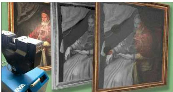
Diapason consente di realizzare un **modello 3D multispettrale** dell'opera oggetto di indagine, grazie alla 7 lunghezze d'onda del laser scanner – dall'ultravioletto fino al primo infrarosso – che permettono di **acquisire immagini non alterate dalla luce ambientale** superando i limiti dei dispositivi oggi in commercio. Queste caratteristiche lo rendono uno strumento adatto per valutare più facilmente lo **'stato di salute' di quadri, affreschi, opere scultoree e siti archeologici**.
